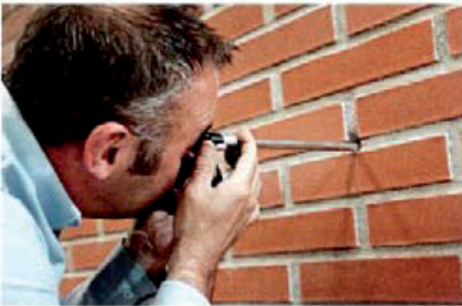
Previamente a su aplicación, es necesario comprobar las características y el estado de la cámara.
