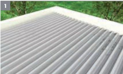
Le Roofboard DDP-U est compatible avec une sous-construction conçue en tôles profilées métalliques, en structure pierreuse (béton ou terre cuite), ou en structure en bois. Veiller à ce que la structure portante soit sèche, propre et régulière et la recouvrir ensuite d'un écran pare-vapeur adapté.
