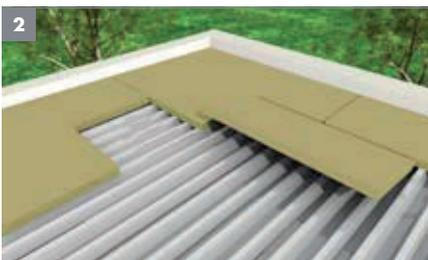
Poser les panneaux isolants jointivement et en quinconce (pas de joints verticaux continus). Pour un complexe toiture en tôles profilées métalliques, les panneaux doivent être posés perpendiculairement à la direction des ondes des tôles.
