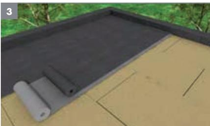
Les panneaux d'isolation peuvent être recouverts d'une étanchéité selon les systèmes de fixation suivants :
