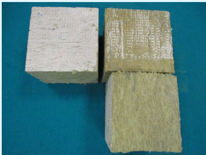
Fotografia di alcuni provini, dall'alto in basso, spessore nominale 80 mm, 120 mm e 180 mm
